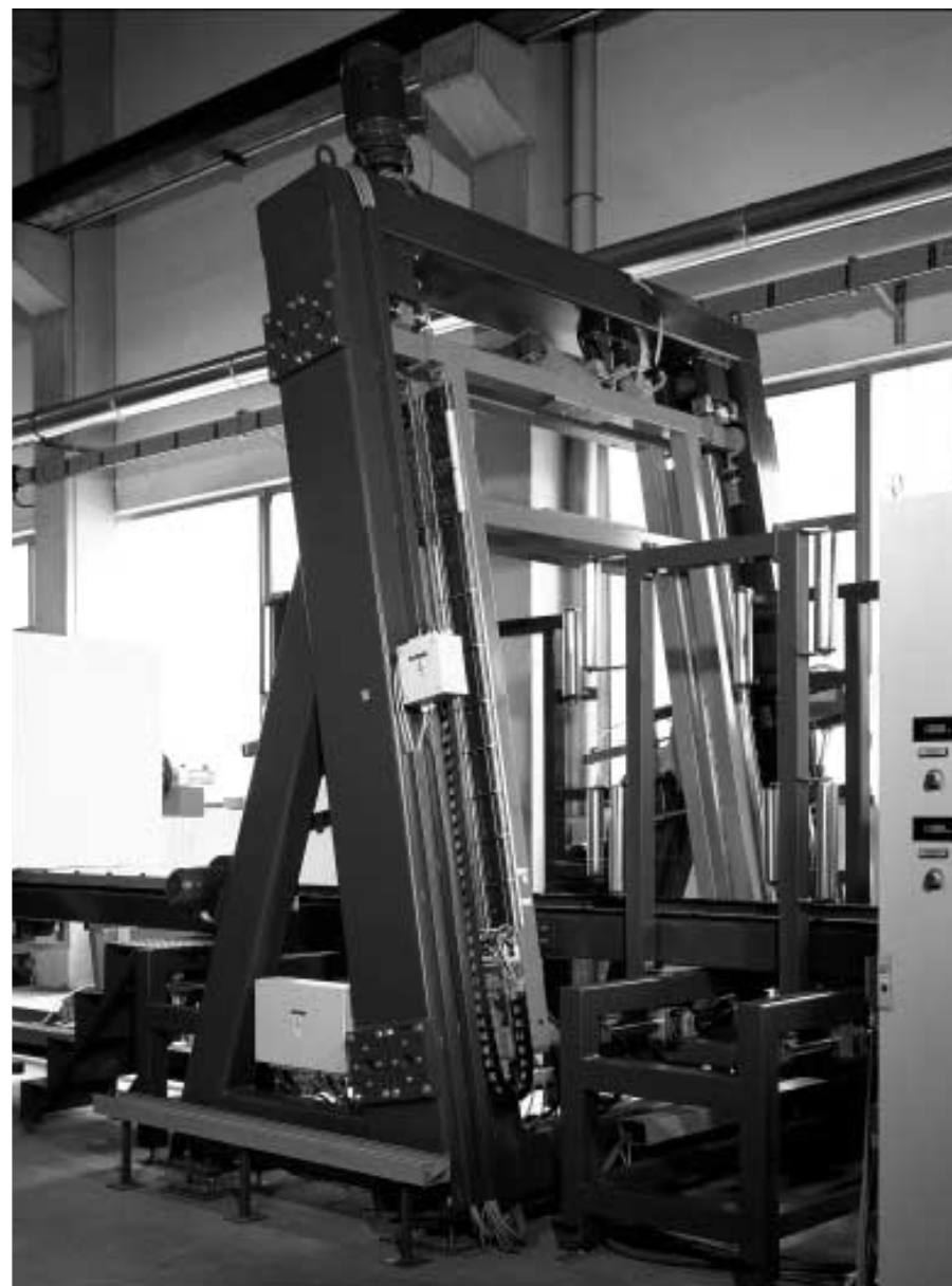
Abb.: Schneidanlage: Plattenschneidstation mit Langhubeinrichtung und automatischer Drahtfernverstellung
