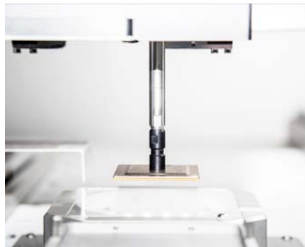
Metallisches BGA über dem Licht-Dome zur Erfassung der Bauteilanschlüsse
