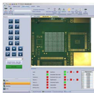
Überlagern von Bauteil und Zielposition
