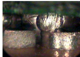
BGA: schlechte Ausrichtung
