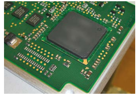
PBGA auf Aluminiumverbundplatte
