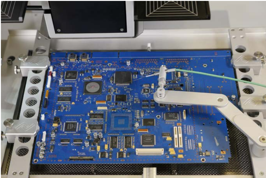
Bearbeitung einer Baugruppe im HR 550
