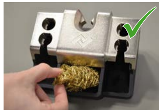
Verschmutzte Metallwolle entfernen, Lotauffangbehälter leeren
