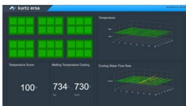
Prozessüberwachung Temperatur & Kühlung
